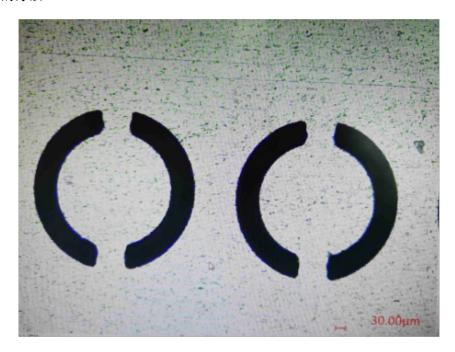
精密小孔激光打孔机采用进口微孔聚焦镜头,光速聚焦效果更佳,打孔精度更精确,能实现单个打孔、多个打孔、群打孔。简单易懂的操作打孔界面,加上高效稳定的编程和兼容多种CAD[CDR[IA[PDF等格式,搭配品牌工控电脑高配置系统,整机运行速度快、无卡顿,可快速处理复杂打孔图形,让微小孔加工更简单。
